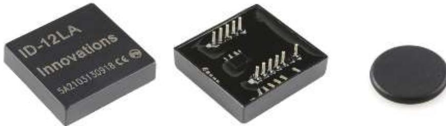
**Figura 56.** Lector RFID (vista desde arriba y desde abajo) y *tag* RFID (del tamaño de un botón)
