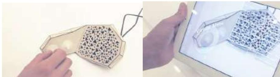
**Figura 17.** Izq. Radio física con volumen y emisora, Der. GUI virtual con funcionalidades añadidas [17]
