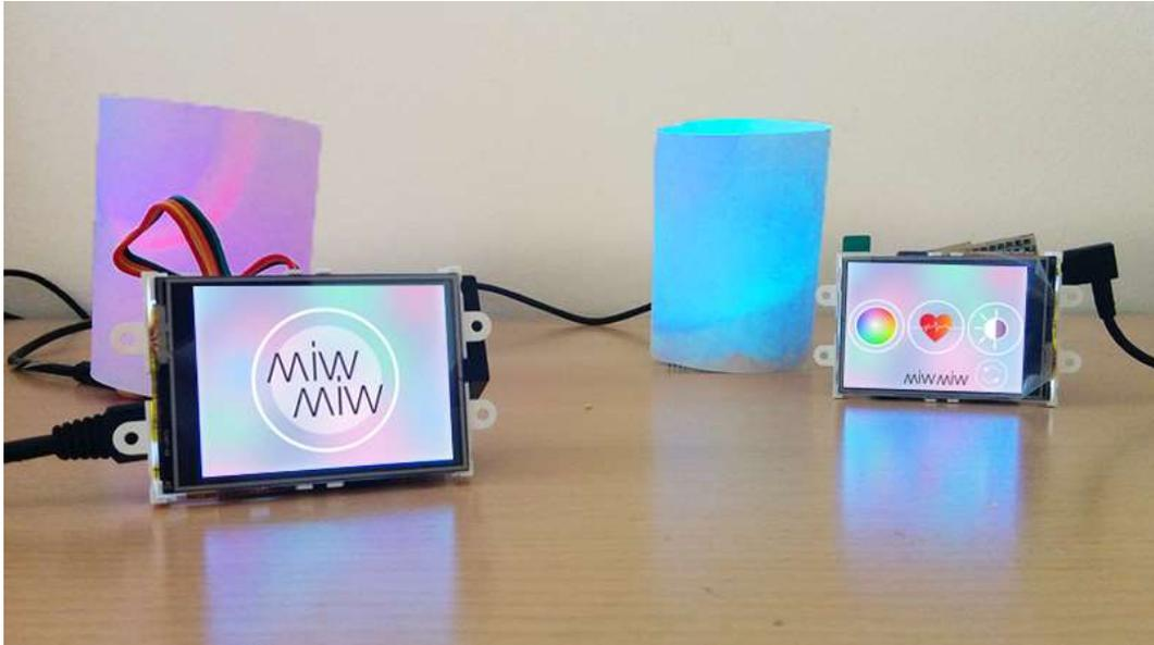
**Figura 44.** Prototipo implementado (2 MiwMiws, 2 luces y un *tag* que representa la radio)
