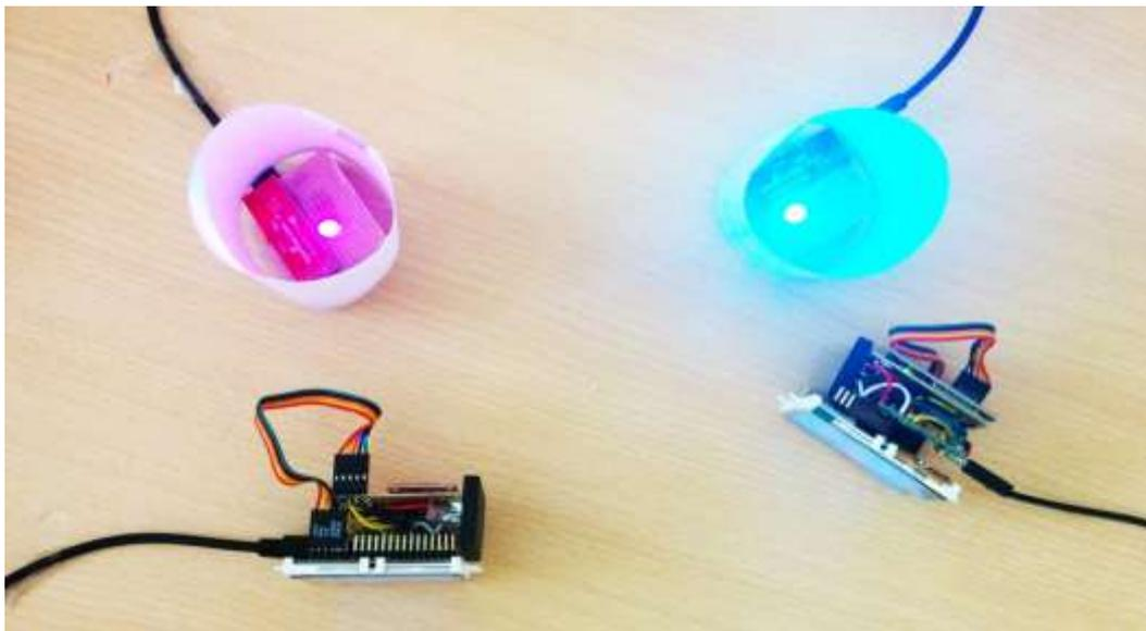
**Figura 48.** Vista superior del montaje de 2 MiwMiws y 2 luces (objetos activos). El objeto pasivo no está presente en la imagen.
