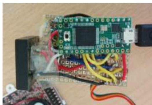
**Figura 59.** Vista de la Teensy y la placa de baquelita debajo. El RFID está a un lado y la pantalla LCD debajo, conectada a través del cable serie.
